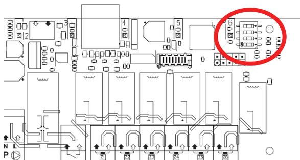
**Nastavení přepínače DIP od výrobce: OFF**
