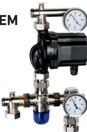
Směšovací stanice zásobuje rozdělovače topných okruhů požadovaným objemovým proudem, přičemž reguluje a monitoruje přívodní teplotu.
